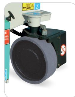
Sterzo idraulico a 90°
